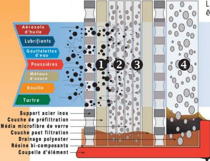
L'air comprimé, chargé de polluants va être graduellement purifié par son passage au travers des multiples étages de filtration où vont s'enchaîner les différentes techniques de filtration
